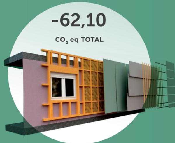
Con la fachada de muro cortina industrializada se consigue una reducción de un 45% de CO<sub>2</sub>eq/m<sup>2</sup>.
